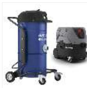
شفاطات للغبار مزودة بفلتر من فئة M، توصل بماكينات الجلي لتأمين موقع عمل خال من الغبار. مصنوعة من ألبوليستر الصلب أو الفولاذ. محرك واحد أو محركان لسحب الغبار سرعة تفريغ الهواء: ٤٠٠ أو ٥٠٠ لتر / دقيقة سعة خزان الغبار: ٣٣ أو ٣٧ لتر
